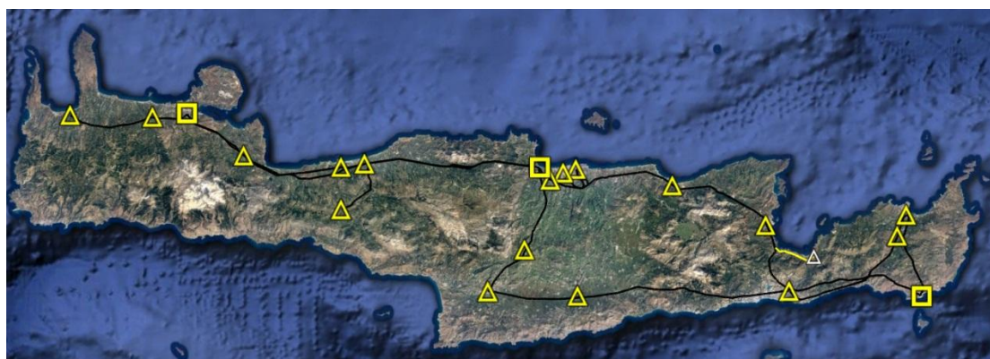
Εικόνα 10: Το Σύστημα Μεταφοράς Κρήτης, Με τετράγωνο σημειώνονται οι σταθμοί ανύψωσης ενώ με τρίγωνα οι σταθμοί υποβιβασμού. Με λευκό χρώμα ο ΥΣ Παχειάς Άμμου που βρίσκεται εκτός λειτουργίας. (Πηγή: Google Earth, Map Data: Data SIO, NOAA, U. S. Navy, NGA, GEBCO, Image Landsat / Copernicus)
